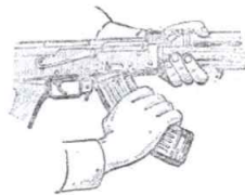
Рисунок 9. Присоединение магазина к автомату
